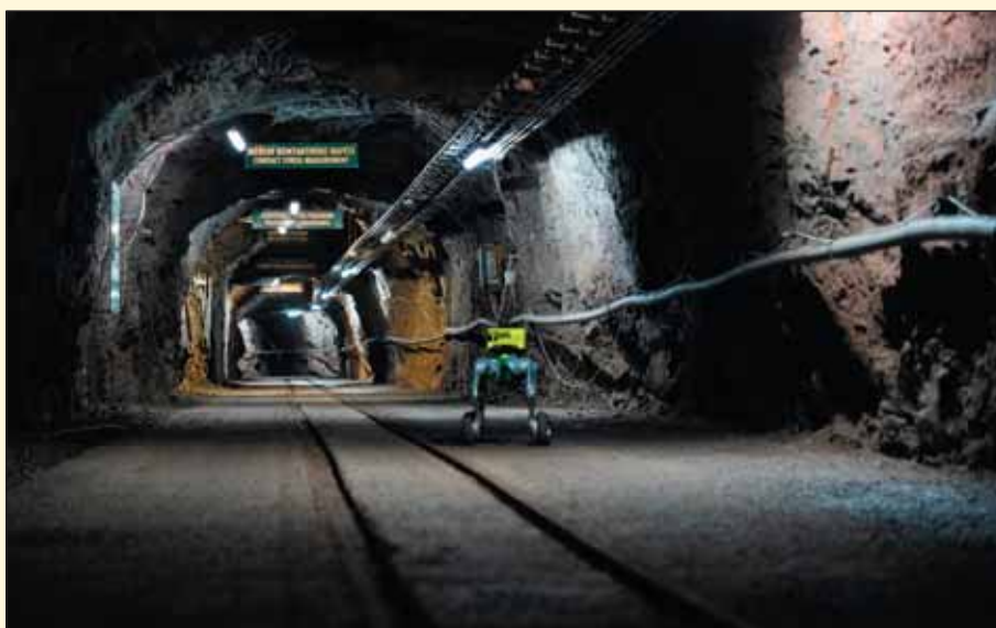
Obr. 1 Jedna z možností automatizovaného monitoringu – využití tzv. robopsů Fig. 1 One of the possibilities of automated monitoring – the usage of so called robodogs
