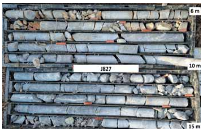
Obr. 6 Jádru vrtu J827 zastihující pararuly v různém stupni porušení Fig. 6 Core from borehole J827 showing paragneisses with varying degrees of weathering and disturbance
