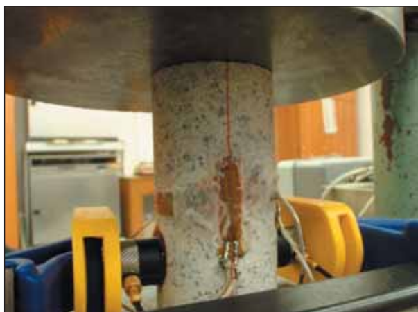
Obr. 3 Stanovení modulu pružnosti během jednoosého stlačování pomocí odporových tenzometrů a ultrazvukového prozařování
