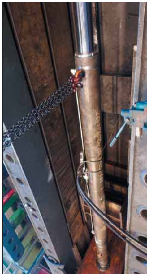
Obr. 4 Zkouška podstavného válce na vzpěr a zkouška těsnosti Fig. 4 Buckling test of a pedestal cylinder and tightness test
