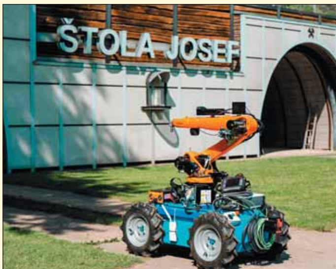
Obr. 2 Univerzitní robot pro inspekci a monitoring podzemních staveb, pracovníě označený JULBOT
