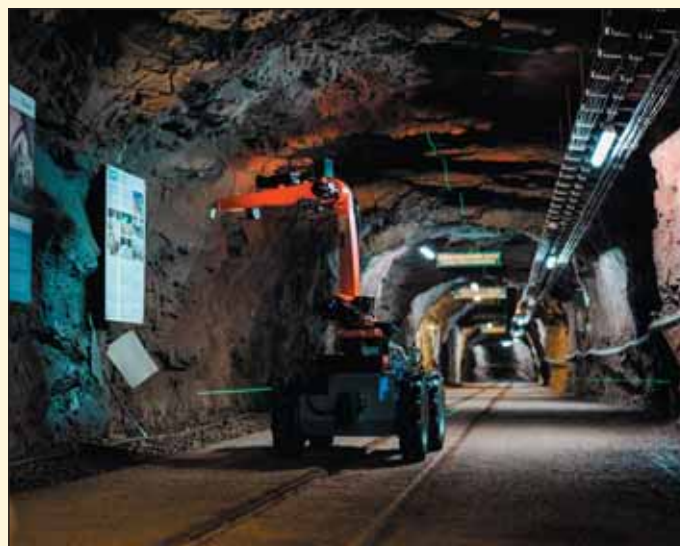
Obr. 3 JULBOT představuje dálkově řízenou platformu se senzory, které umožňují komplexně vnímat a analyzovat okolní prostor včetně detekce a semi-autonomní identifikace různých objektů
