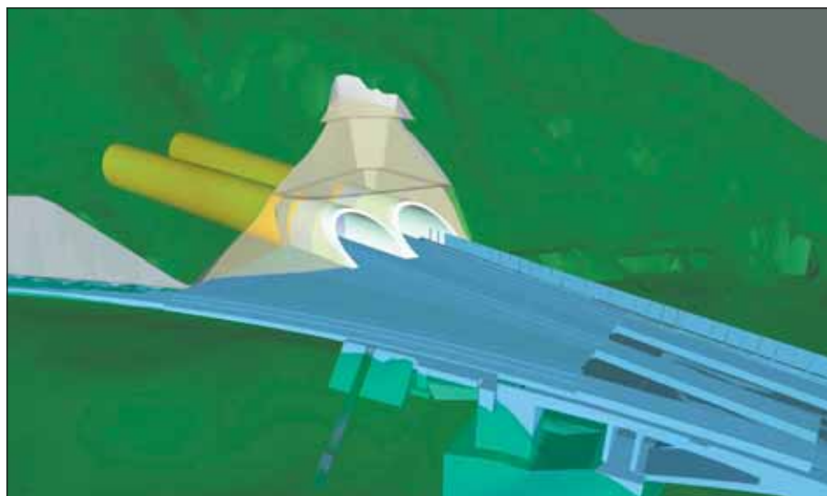
Obr. 8 Portál Branický most – 3D koordinační model Navisworks Fig. 8 Branický Bridge portal – 3D coordination model Navisworks
