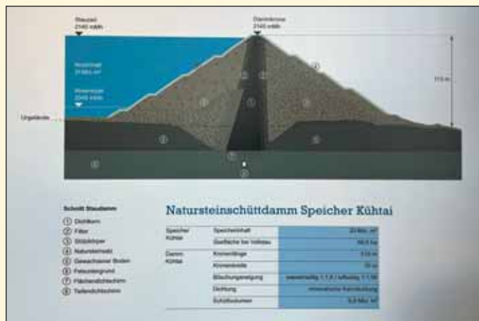
Obr. 1 Skladba budované hráze pod budoucím jezerem na projektu Kühltai Fig. 1 Composition of the dam being built under the future lake at the Kühltai project
