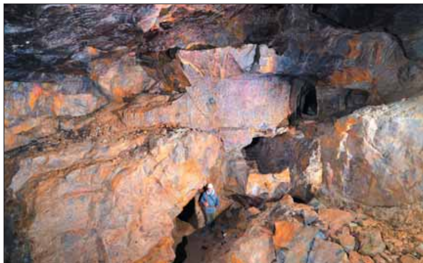
Obr. 4 Komorové dobývání tzv. šířením
