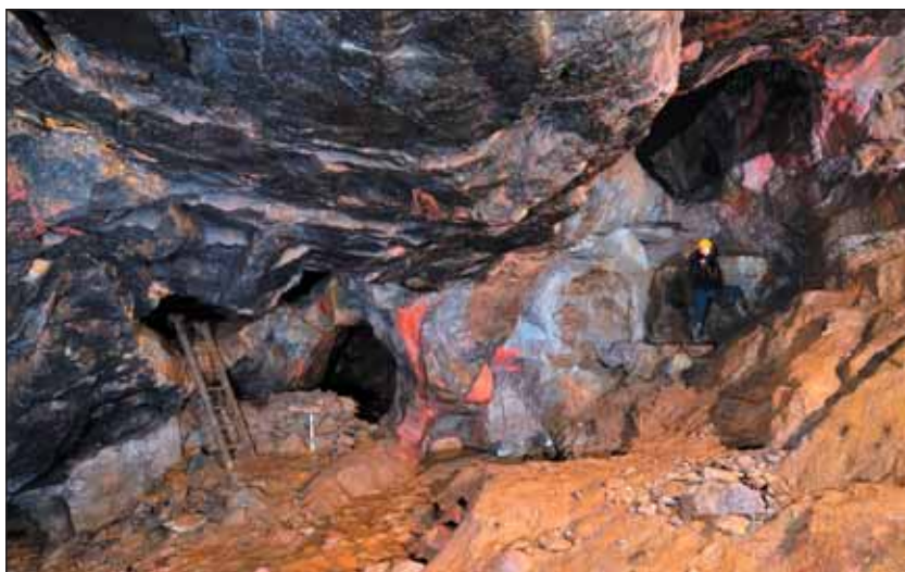
Obr. 2 Příklad rozfárání ložiska, komorové dobývání s navazujícími důlními díly
