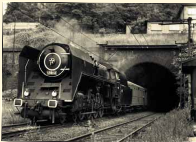
Obr. 2 498.040. Trojčtá rychlíková lokomotiva 2' D1'. Výrobek plzeňské lokomotivky Škoda z roku 1947. Foto © Pavel Vančura. Nakladatelství PressFoto Praha. Okolo 1970 [sbírka autorů].
