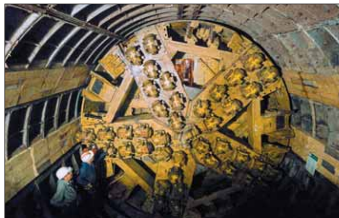
Obr. 7 Řezná hlava mechanizovaného štítu TŠČB-3 Fig. 7 Cutting head of the mechanised shield TŠČB-3
