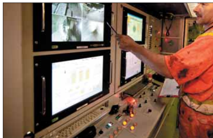
Obr. 13 Strojník v pilotní kabině zeminového štítu S-609 Fig. 13 Machine operator in pilot's cabin of earth pressure balance shield S-609
