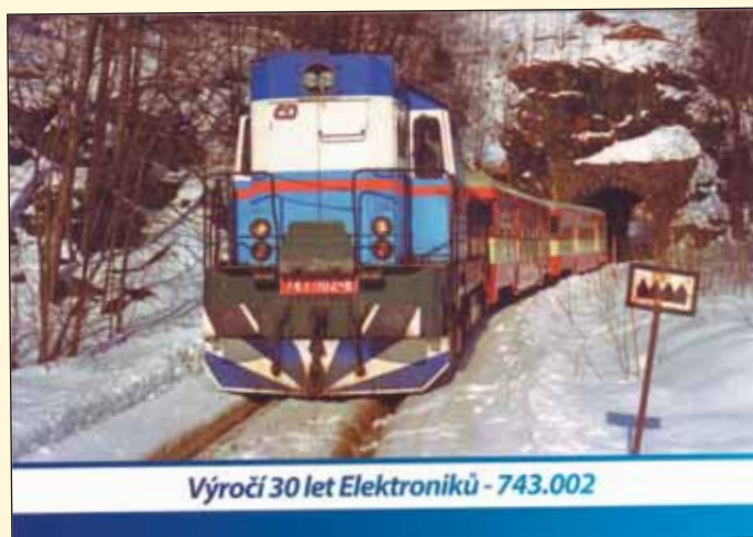
Obr. 3 Výročí 30 let Elektroniků – 743.002. Motorová lokomotiva 743.002 v čele osobního vlaku z Harrachova do Tanvaldu sjíždí dne 27. února 2000 poslední ozubnicový úsek mezi Desnou a Tanvaldem, a to již nedaleko cílové stanice tohoto vlaku. Ozubnicové hřebeny v ose kolejnic jsou skryty pod vrstvou sněhu. © SURA s. r. o. Rokytnice nad Jizerou, foto: Karel Hanuš. 2000. [sbírka autorů]
