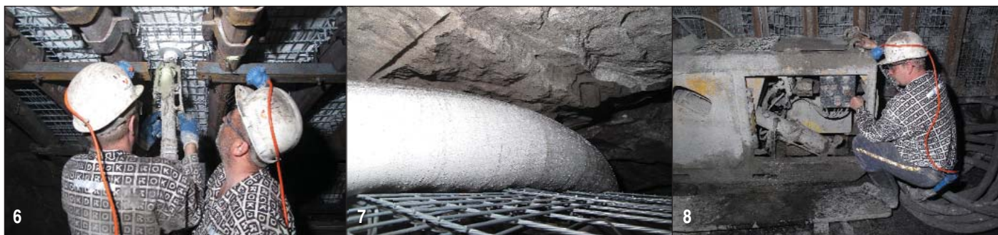
Obr. 6, 7 a 8 Technologie vyplňování volných prostor „vakováním nad výztuží“ k zabezpečení aktivace důlní výztuže Fig. 6, 7 and 8 Technology of filling empty spaces by placing bags above the support ribs designed to activate the colliery arches
