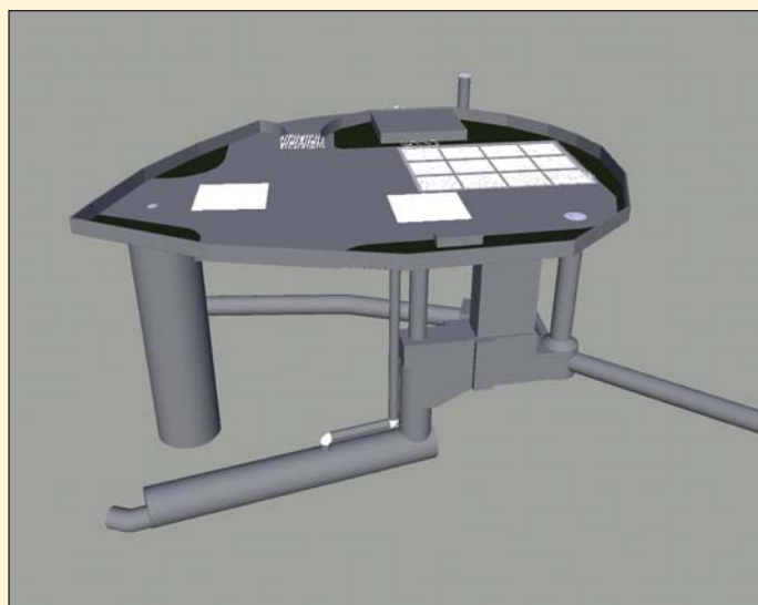
Obr. 3 3D model komplexní šachty Fig. 3 Gate shaft 3D model
