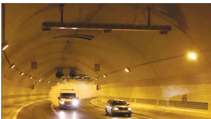
Obr. 8 Zkoušky algoritmu detekce kouře s pohybujícím se zdrojem kouře
