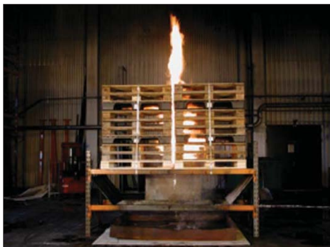
Obr. 1 Volné odhořívání dřevěných palet pod průmyslovým kalorimetrem Fig. 1 Free process of burning wooden pallets under an industrial calorimeter
