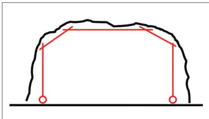
Obr. 15 Navržený systém požární ochrany pro zkoušky v tunelu Runehamar Fig. 15 Fire protection system designed for testing in the Runehamar tunnel
