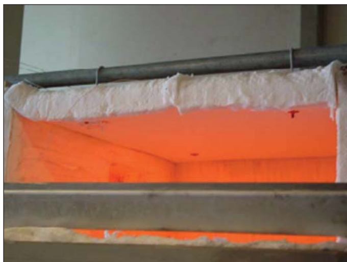
Obr. 3 Ohřívání desky PROMATECT®-T a jejich upevnění Fig. 3 Heated PROMATECT®-T boards and their fixation
