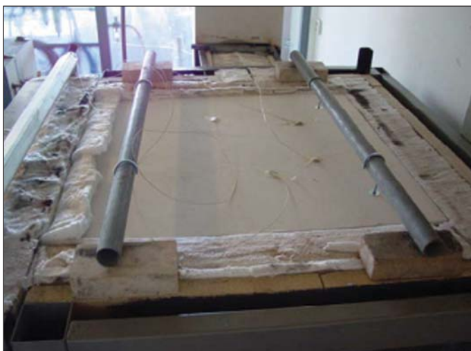
Obr. 2 Zavěšení zkušebního panelu v průběhu zkoušky Fig. 2 Hanging a test board during the course of the test
