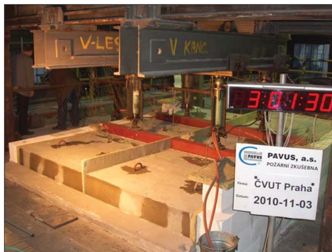
Obr. 11 Stav ostění po 180 minutách – minimální deformace
