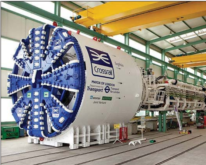
Obr. 4 Razicí štít (kombinovaný štít) v továrně Herrenknecht Fig. 4 Mixshield TBM, factory acceptance
