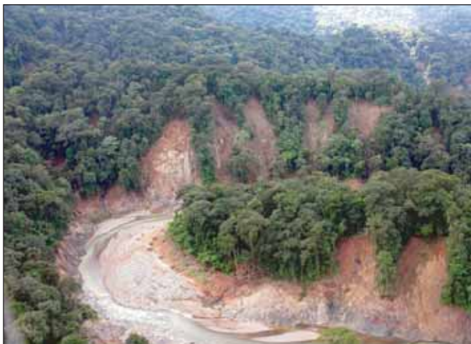
Obr. 6 Svahové deformace na březích řeky Umiray Fig. 6 Slope deformation on the Umiray River banks
