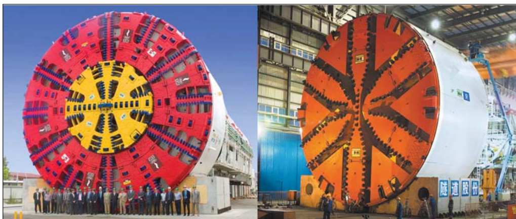
Obr. 1 Trend směrem k větším průměrům: štít EPB (Španělsko, 2005) Ø 15,20 m a štít pro proměnlivé horninové poměry Mixshield (Čína, 2006) Ø 15,43 m (Fotografie: Herrenknecht AG)
