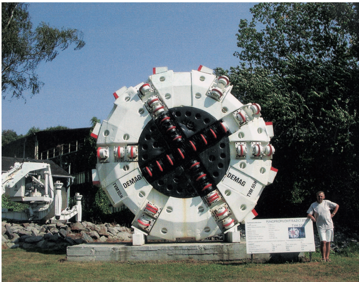
Obr. 5 Vrtací hlava stroje v Hornickém muzeu v Ostravě-Petřkovicích Fig. 5 Cutterhead of TBM in the Museum of Mining in Ostrava-Petřkovicce
