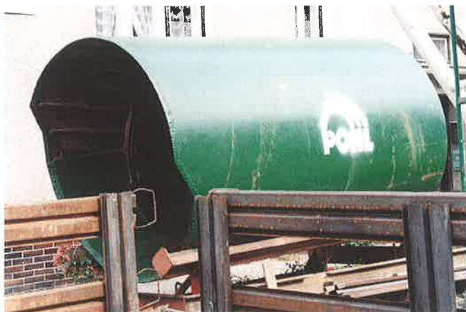
Obr. 1 Razicí nemechanizovaný štít DN 2000 mm Fig. 1 Non-mechanised shield DN 2000 mm
