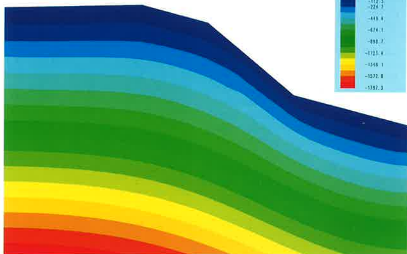
Obr. 3/1 Průběh vertikálního napětí v jednotlivých fázích ražby tunelu Fig. 3/1 Course of the vertical stress in individual stages of the tunnel drive
