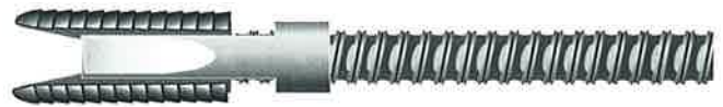
Obr. 3 Závrtný svorník s kotevní hlavíci Fig. 3 Self - drillig bolt with anchorable head
