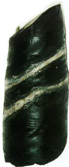
Obr. 1: Proinjektované diskontinuity libeňských břidlic vysokotlakou injektáží Discontinuities of Libeň shales injected by high pressure grouting
