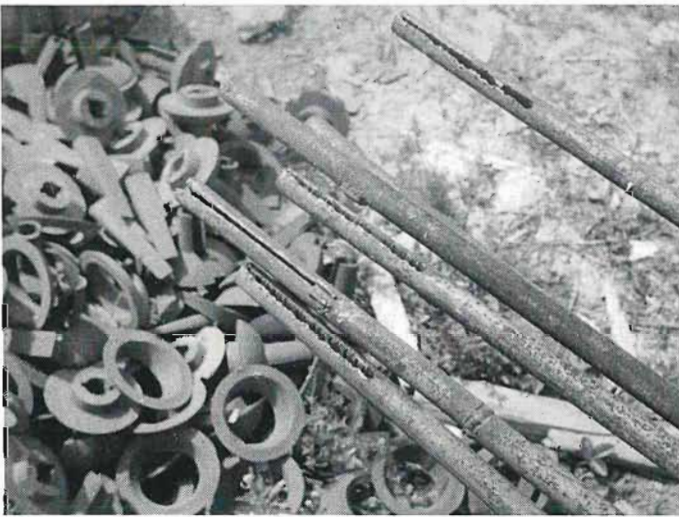
Ocelové svorníky s rozštěpem na konci, klíny k uchycení a půlkulovité podložky pod záhlaví kotev
