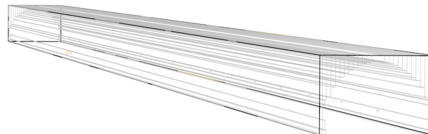
Zjednodušená geometrie tunelu ve FDS
