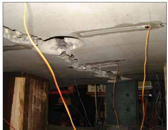
Obr. 4 Segment zatížený ohybem kolmo na rovinu segmentu po porušení (pohled zespoda)
