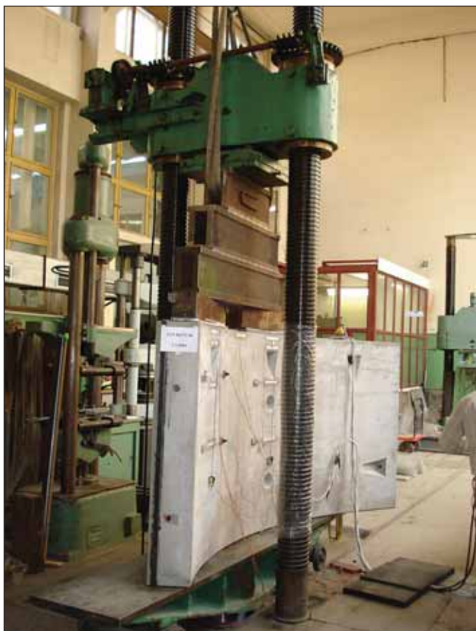
Obr. 7 Segment zatížený v prostém tlaku dvěma břemeny Fig. 7 A segment loaded by uniaxial pressure induced by two loads
