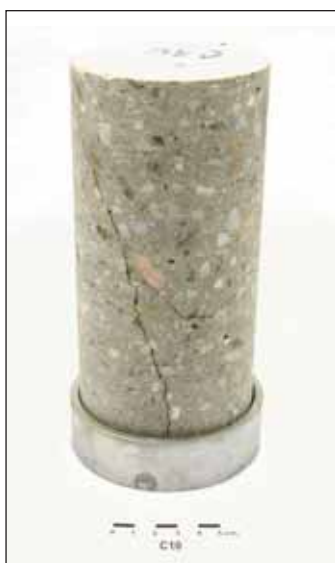
Obr. 4 Vzorek betonu C10 po zkoušce: komorový tlak 2,5 MPa, pracovní tlak 13,5 MPa, čas nástupu 20 s, čas po dosažení pracovního tlaku 180 s (foto ISATech)
