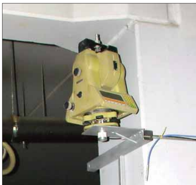
Obr. 2 Stanoviště totální stanice v podzemních garážích komplexu „Hvězda“ (foto sdružení Arcadis – Inset)
