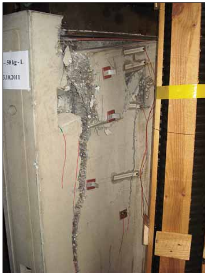
Obr. 6 Rozštípnutí zbytku segmentu příčnými tahy
