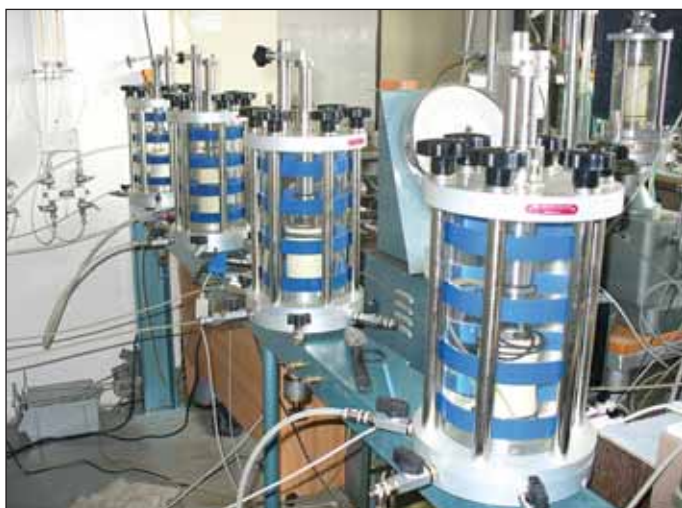
Obr. 5 Tlakové komory pro měření hydraulické vodivosti horninových vzorků Fig. 5 Pressure triaxials cells for measuring hydraulic conductivity of rock specimens
