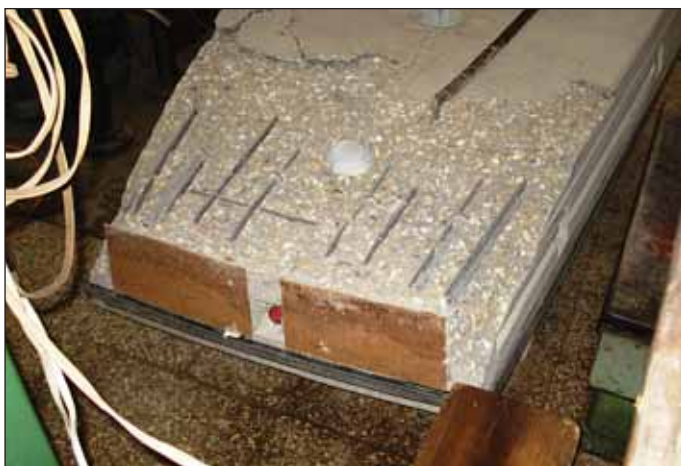
Obr. 8–11 Delaminace železobetonových segmentů zatížených prostým tlakem Figures 8–11 Delamination of traditionally reinforced concrete segments loaded by unilateral pressure
