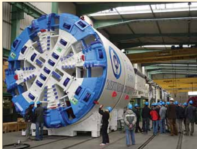
Obr. 3 TBM \phi 6 m připravený pro Baku (Ázerbajdžán)
