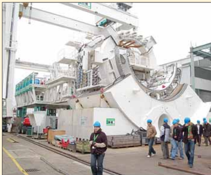
Obr. 5 Montáž největšího TBM \phi 15,55 m pro Itálii
