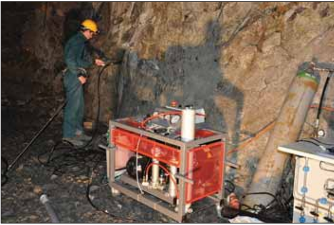
Obr. 4 In-situ testování plynopropustnosti Fig. 4 In situ testing of gas permeability
