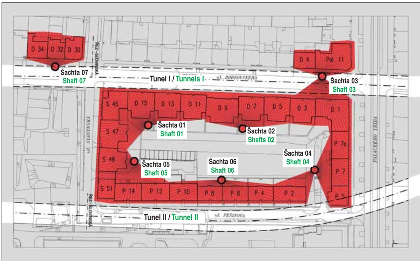
Obr. 2 Situace objektů vybraných pro zabezpečení kompenzační injektáží včetně souvisejícího rozmístění injektážních šachet bloku Fig. 2 Layout of the buildings selected for supporting by compensation grouting, including associated locations of grouting shafts for the block
