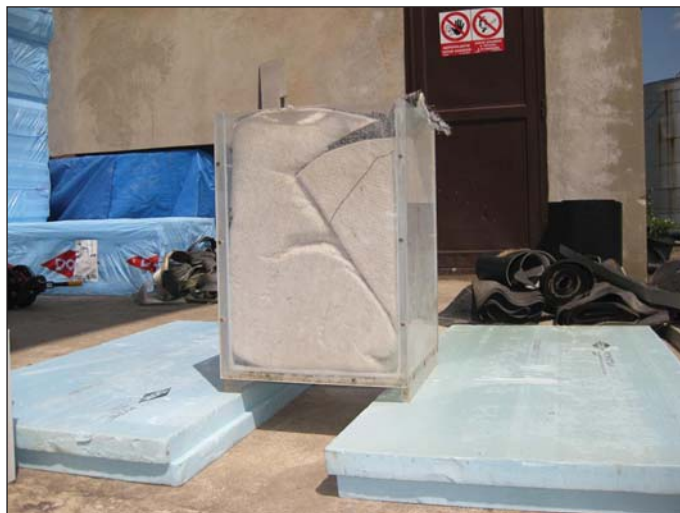
Obr. 4 Zkouška funkce izolace VOLTEX (typ 1) – nádoba před napuštěním vodou
