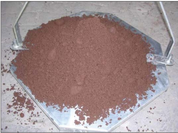
Obr. 3 a 4 Zkoušky sednutí kužele, které ukazují na odlišnou konzistenci vzorku přírodní horniny a vzorku téže horniny upravené výrobkem POLYFOAMER FP Figures 3 and 4 Slump tests referring to the different consistency of the natural ground sample and a sample of the same ground conditioned with POLYFOAMER FP
