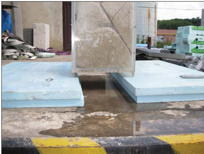
Obr. 6 Zkouška funkce izolace VOLTEX (typ 1) – vytékající vody z nádoby Fig. 6 Testing of VOLTEX waterproofing material function (type 1) – water leaking from the vessel
