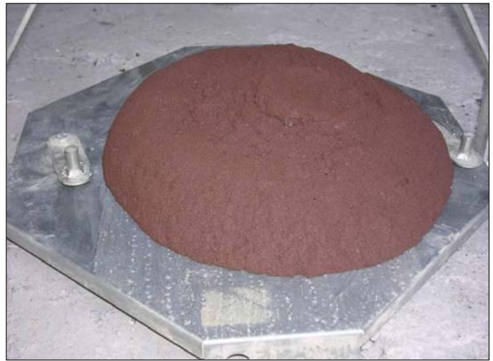
Obr. 3 a 4 Zkoušky sednutí kužele, které ukazují na odlišnou konzistenci vzorku přírodní horniny a vzorku téže horniny upravené výrobkem POLYFOAMER FP Figures 3 and 4 Slump tests referring to the different consistency of the natural ground sample and a sample of the same ground conditioned with POLYFOAMER FP
