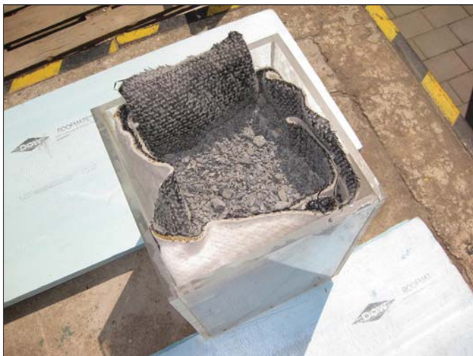
Obr. 3 Zkouška funkce izolace VOLTEX (typ 1) – vysypání nádoby frakcí 8–32 mm
