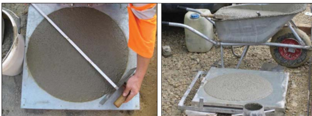
Obr. 1 Rozlívání kužele betonové směsi 6 (vlevo) a 6a (vpravo) Fig. 1 Slump of mixture 6 (left) and 6a (right)
