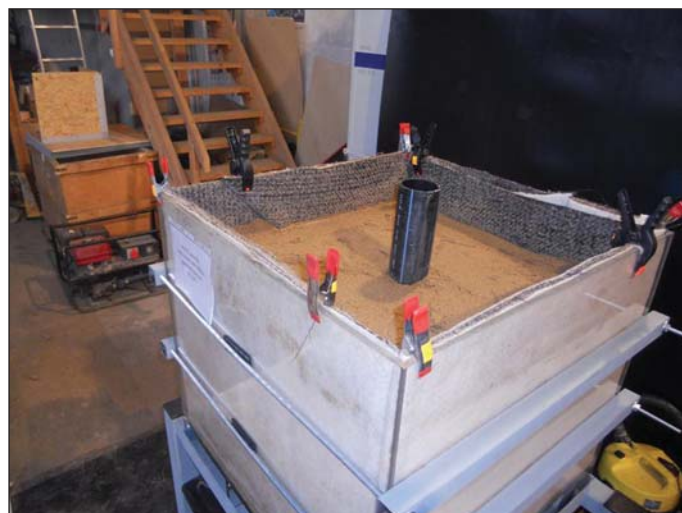
Obr. 8 Zkouška funkce izolace VOLTEX (typ 2) – nádoba před napuštěním vodou Fig. 8 Testing of VOLTEX waterproofing material function (type 2) – the vessel before filling with water
