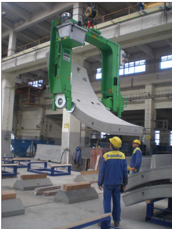
Obr. 2 Manipulace se segmenty během výroby Fig. 2 Segments handling during production
