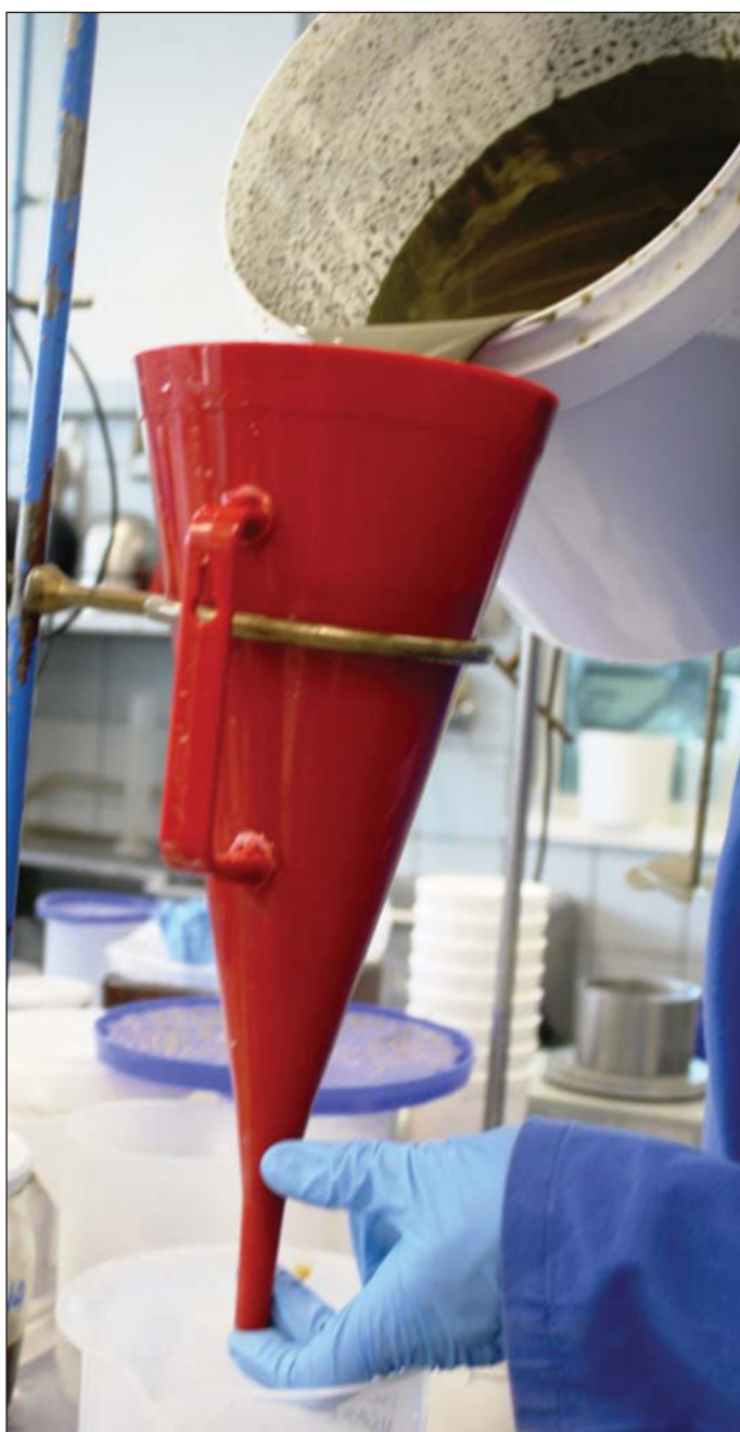
Obr. 5 Ukázka testu viskozity dvousložkové směsi Fig. 5 Example of two-component mixture viscosity test
