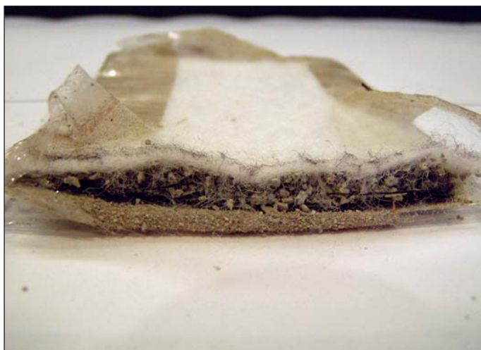
Obr. 2 Řez bentonitovou rohoží VOLTEX Fig. 2 Section through a VOLTEX bentonite mat
