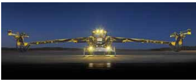
Obr. 3 Vrtací stroj firmy Atlas Copco – Boomer E2C Fig. 3 Atlas Copco Boomer E2C drill rig
