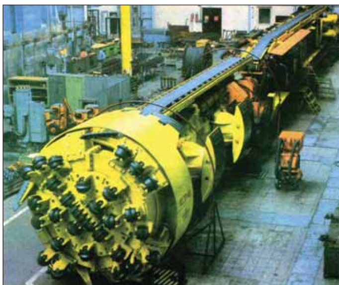
Obr. 1 Razičí stroj RS 37–40 v montážní hale Fig. 1 RS 37–40 tunnelling machine in an assembly hall
