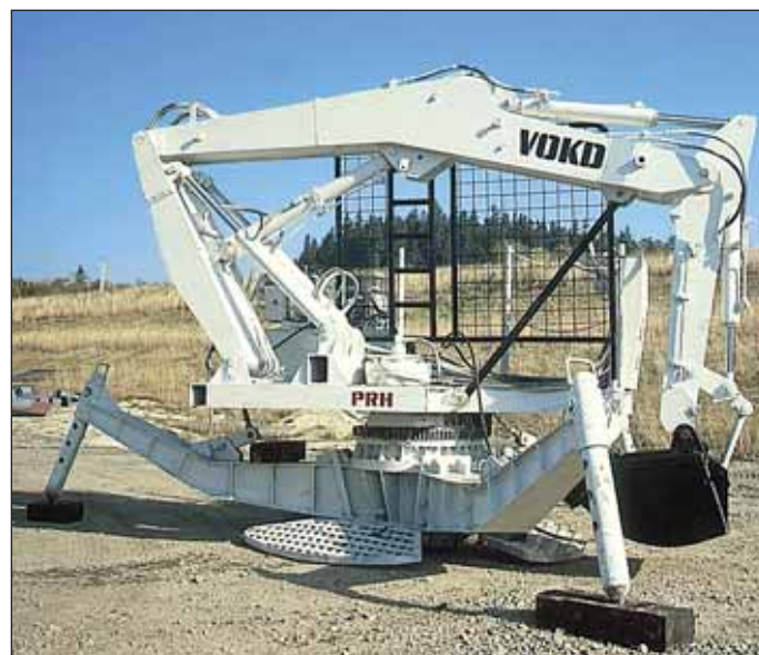
Obr. 10 Nakládací zařízení PRH-1 vyvinuté VOKD Fig. 10 PRH-1 loading equipment developed by VOKD
