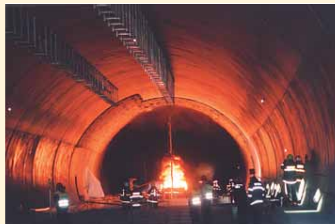
Obr. 1 Zkušební požár v plné intenzitě Fig. 1 Full-intensity test fire
