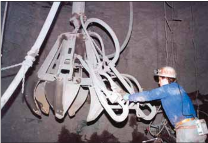
Obr. 3 Ručně naváděný nakladač KS-3 Fig. 3 KS-3 manually operated loader
