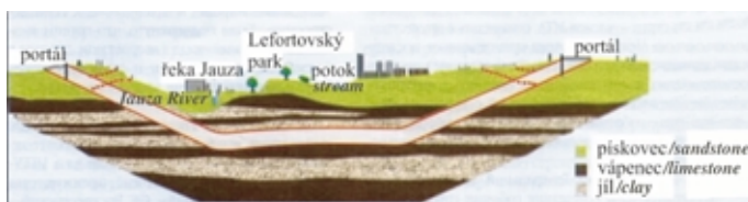
Obr. 1 Podélný profil tunelu
