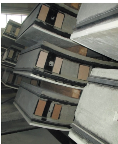
Obr. 4 Detail ze skladu železobetonových dílců. Vše je provedeno s maximální precizností. Každý díl je označen a má své místo ve skladu. Fig. 4 Detail from storage of the reinforced concrete lining. Everything is carried out with highest precision. Every piece is labeled and has its place in the storage
