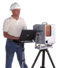
Obr. 1 3D laserový skener Cyrax 2500 při měření Fig. 1 3D laser scanner Cyrax 2500 during measurement
