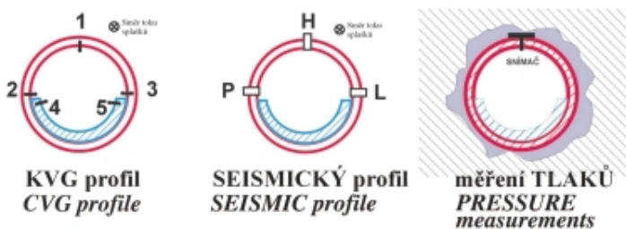
Obr. 9 Měření prováděná v místě křížení VTT a sběrače. Tlak za obzdvívkou byl měřen pouze pod ZTT
