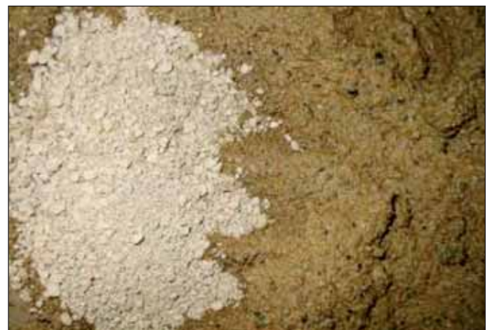
Obr. 6 Porovnání původní zcela suché pórovité zeminy a homogenní pasty ze zeminy po jejím smíchání s pěnou a polymerem
