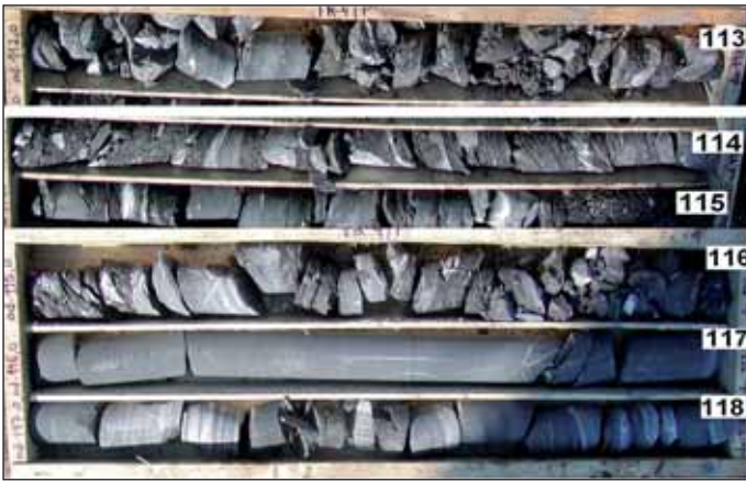
Obr. 7 Horninová nerovnorodosť odrážajúca premenlivú litológiu (vrt TR-4P – tunel Rojkov). V hĺbke 113–116 m prevládajú slienité bridlice miestami tektonicky porušené (charakter zeminy) a od 117 do 118 m p. t. slienité vápence (použitá fotodokumentácia zo správy Grenčíková a kol., 2008)
