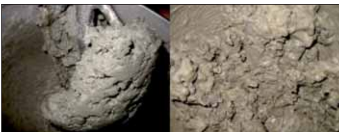
Obr. 5 Chování jílu bez protijílové přísady a s přísadou Fig. 5 Clay behavior without and with anti-clay agent
