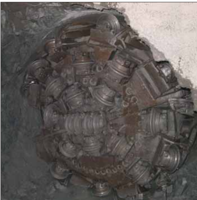
Obr. 6 Průzkumná štola Višňové – řezná hlava TBM Fig. 6 The Višňové exploration gallery – TBM cutterhead
