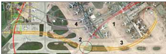
Obr. 10 Situace přechodu tunelů ART nad tunelem trati HEX: 1 - Tunel trati Heathrow Express, 2 - Tunel ART procházející nad tunelem HEX, 3 - Silniční tunel na letištní straně (Airside Road Tunnel - ART), 4 - Nové tunely prodloužení trati HEX (HexEx)
