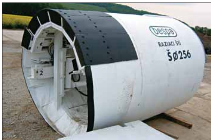
Obr. 4 Raziaci štít s výsuvným nožovým predštítkom Fig. 4 The shield with an extendible cutting blade ("pre-shield")
