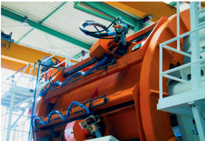
Obr. 7 Rotujúci manipulátor striekacej dýzy (prstencové nanášanie striekaného betónu)
