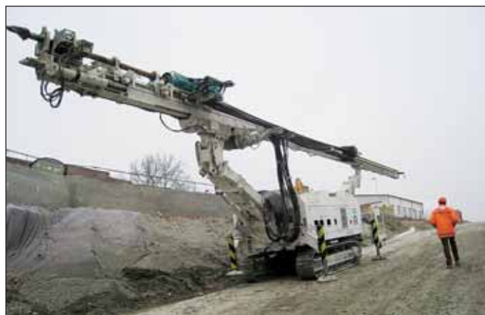
Obr. 5 Vrtačka MKP dešťníků s lafetou dl. 17 m
