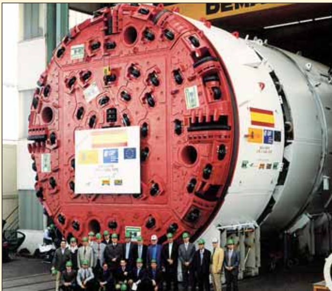
Obr. 6 TBM s dvojitým štítem (Ø 9,50 m, Guadarrama North)
