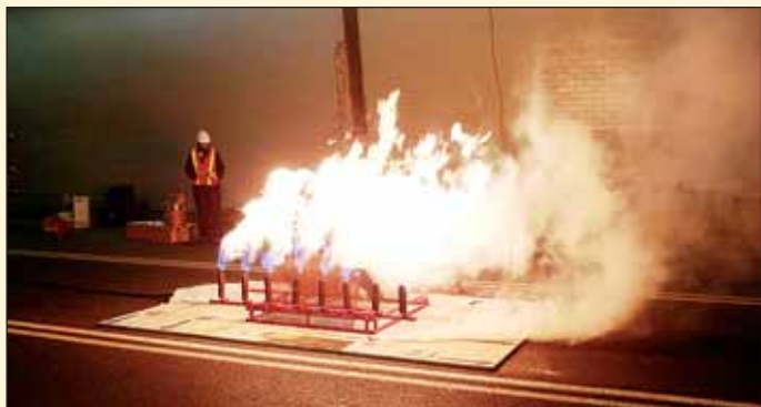
Obr. 4 Hořáky, do jejichž středu jsou vyhazovány dýmovnice Fig. 4 Smoke pots are thrown to the centre of burners
