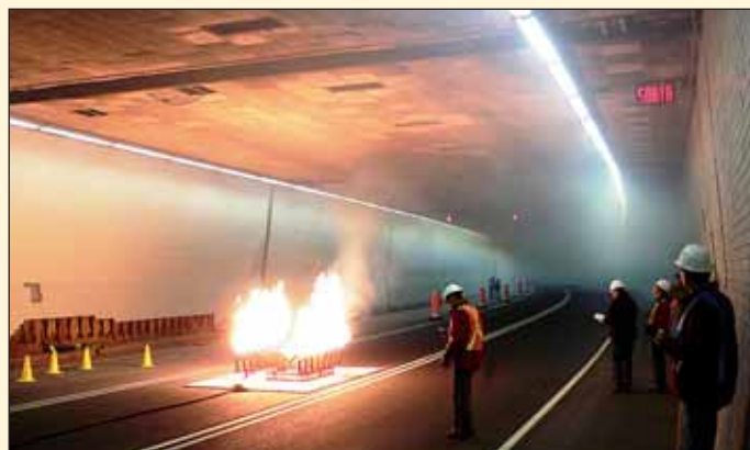
Obr. 5 Vývoj kouře asi po 5 minutách Fig. 5 Smoke development about 5 minutes after the beginning of the test
