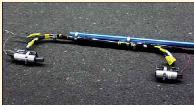
Obr. 3 Jeden ze dvou opacitometrů umístěných na jedné tyči Fig. 3 One of the two opacimeters installed on one pole
