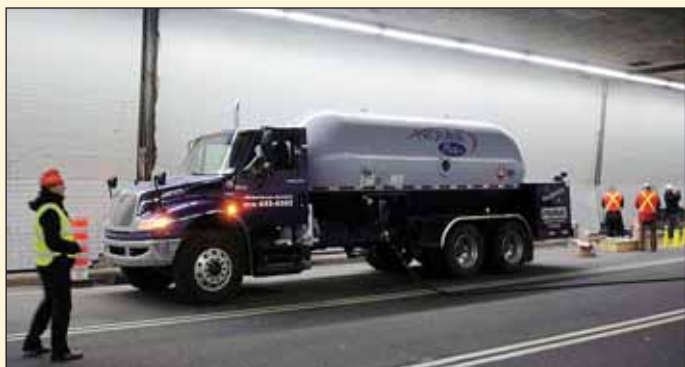
Obr. 2 Cisterna zásobující hořáky propan-butanem Fig. 2 Propane and butane tank supplying the burners
