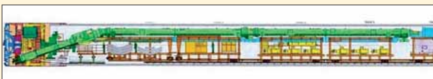
Obr. 10 Úprava šnekového dopravníku (vyznačen zeleně) u zeminového štítu nasazeného v Los Angeles
