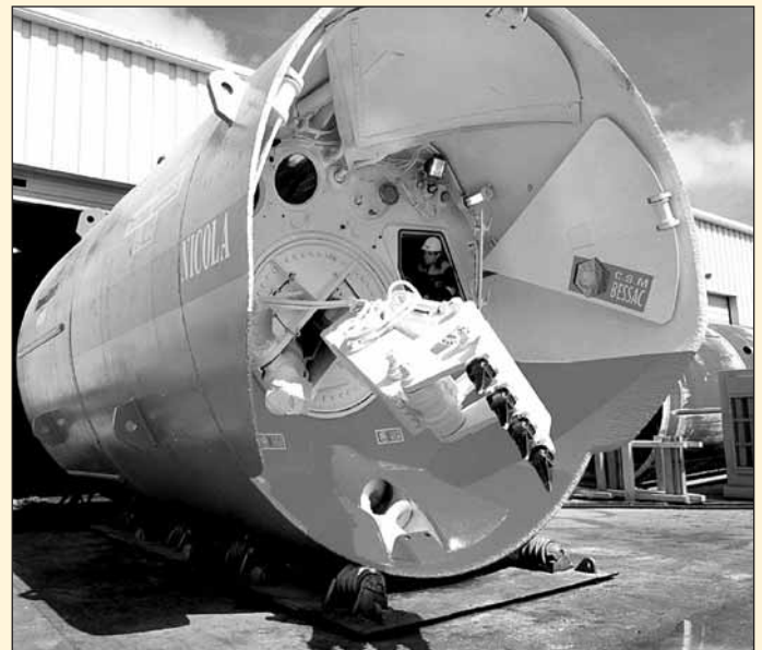
Obr. 7 Štít s postupným pobíráním v čelbě pro tlakový i netlakový režim
