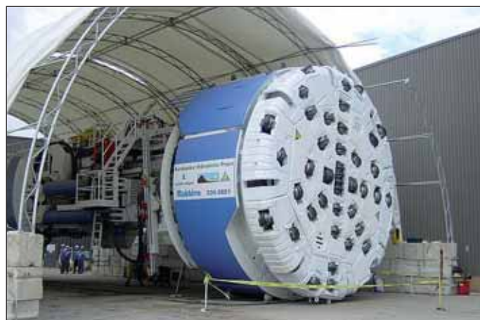
Obr. 5 Tunelovací stroj TBM 3 Fig. 5 TBM 3
