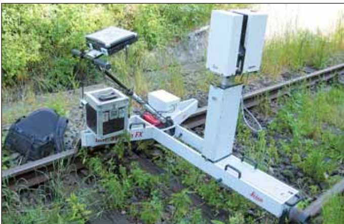
Obr. 1 Leica GRP5000 s možností plynulého pojezdu
