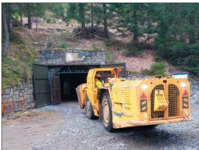
Obr. 4 Nakladač Epiroc před štolou Nový Hackelberk Fig. 4 Epiroc loader in front of Nový Hackelberg adit
