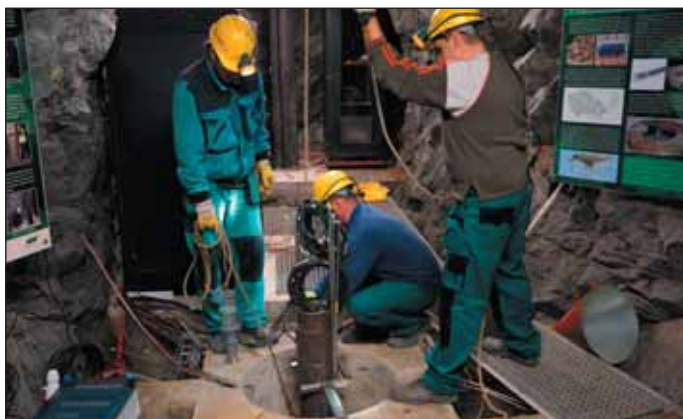
Obr. 5 Experimentální testování inženýrské bariéry z bentonitu teplotou do 200 °C – TAČR TK01030031 Fig. 5 Experimental testing of bentonite engineering barrier with temperature up to 200°C – TAČR TK01030031
