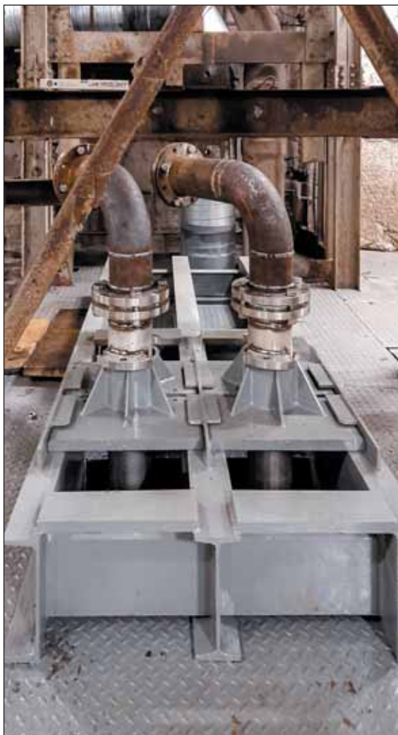
Obr. 5 Ohlubně jámy R7S se zabudovanými výtlačnými řády Fig. 5 R7S shaft bank with built-in force mains
