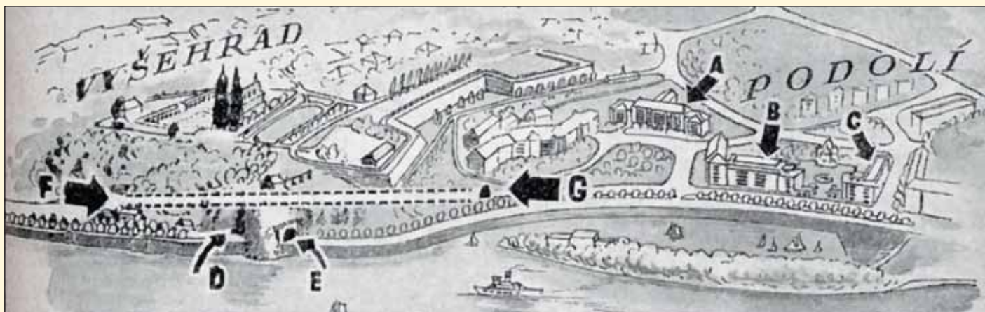
Obr. 7 Poválečný návrh druhého vyšehradského tunelu, A = poliklinika, B–C = obytné domy, D–E = starý tunel, F–G = nový tunel (časopis Nová Praha, 1956) Fig. 7 Post-war design of the second Vyšehrad tunnel, A = polyclinic B–C = residential buildings, D–E = old tunnel, F–G = new tunnel (Nová Praha journal, 1956)
