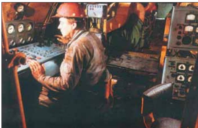
Obr. 6 Strojník na mechanizovaném štítu TŠČB-3 Fig. 6 Machine operator of mechanised shield TŠČB-3
