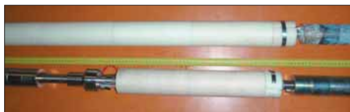
Obr. 4 Těsnění z polyamidu v etážích monitorujících puklinu
