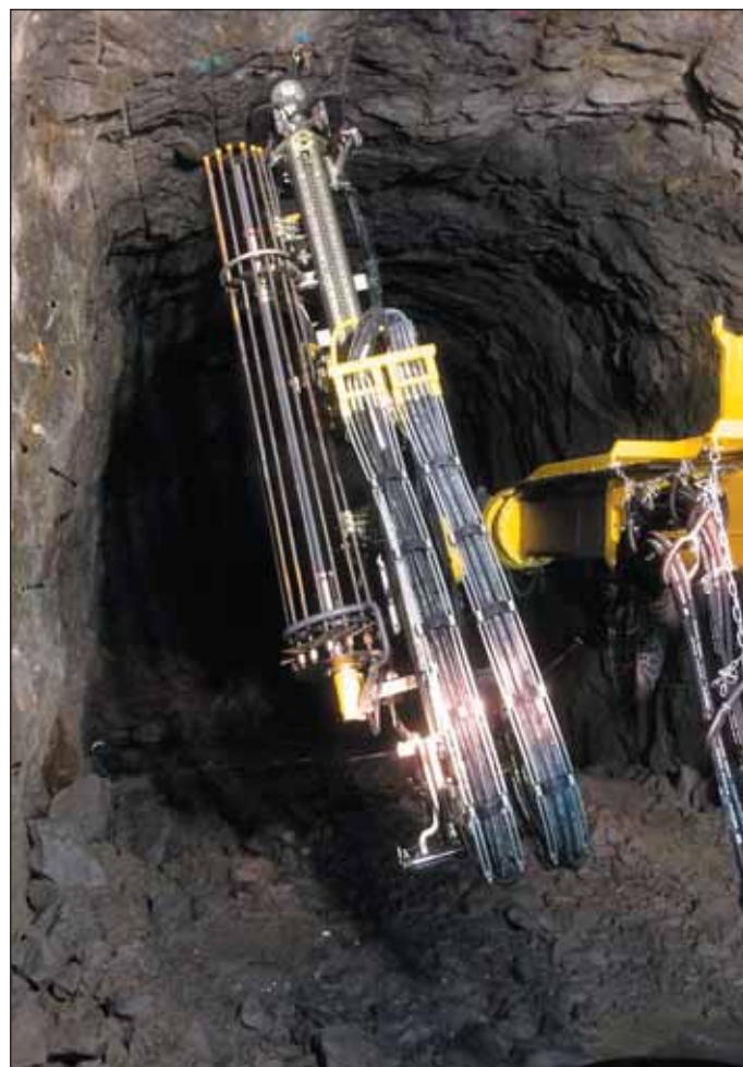
Obr. 9 Naplněný zásobník svorníků na lafetě (navržen pro 10 svorníků) Fig. 9 A preloaded bolt magazine on the feed is designed to hold 10 bolts
