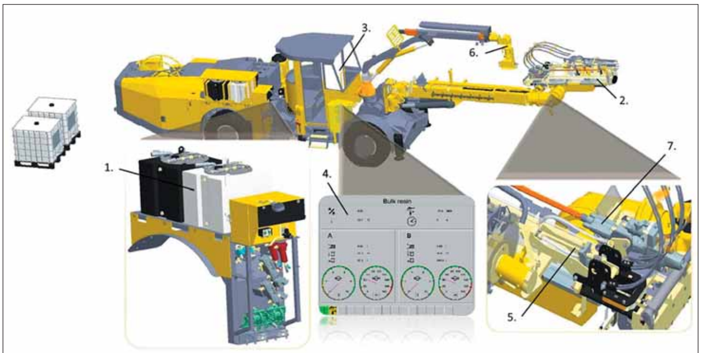
Obr. 1 Svorníkovací stroj Boltec E Bulk Resin se zobrazením funkčních celků systému Fig. 1 The Boltec Bulk Resin machine illustrating functional operations
