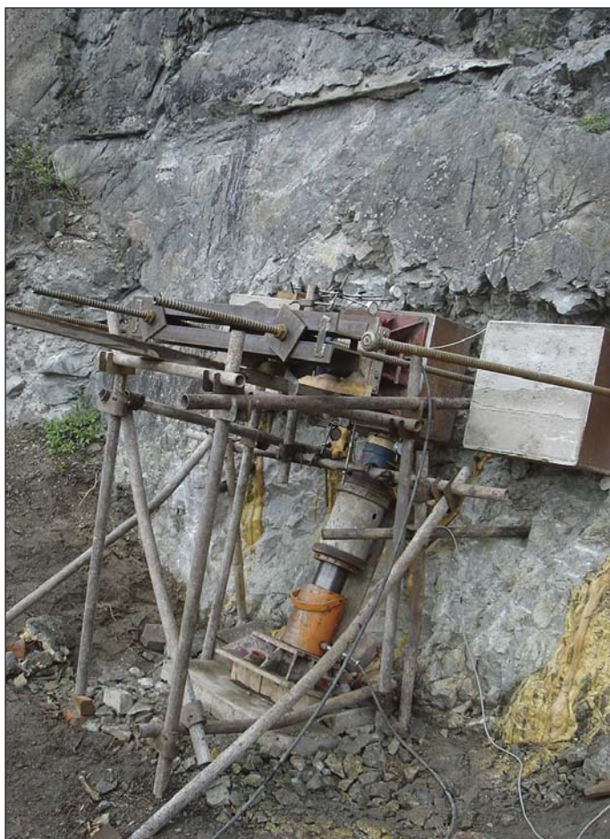
Obr. 4 Sestava pro provedení velkorozměrové smykové zkoušky bloku horniny v místě jižního portálu tunelu Žabovřesky
