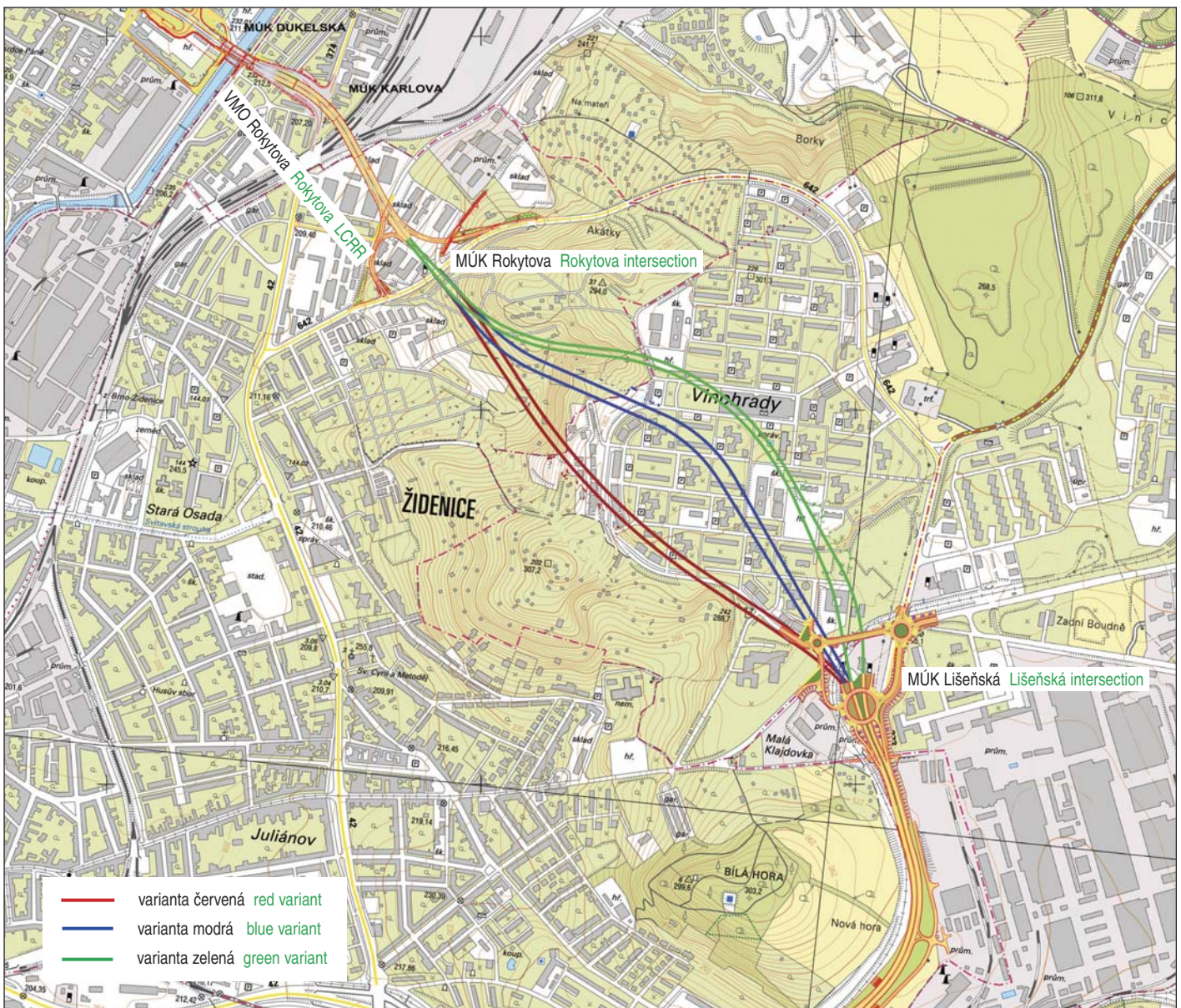
Obr. 2 Situace variant trasování tunelu Vinohrady Fig. 2 Layout of variants of the Vinohrady tunnel alignment
