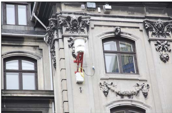
Obr. 3 Totální stanice na fasádě budovy Fig. 3 A total station with its bracket on the building's facade
