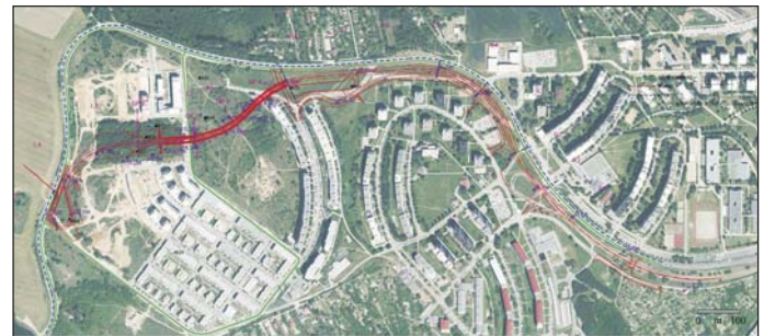
Obr. 6 Situace se zobrazením projektovaného prodloužení tramvajového úseku a umístění tunelu
