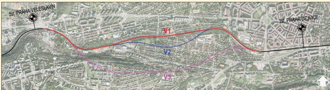
Obr. 1 Varianty podpovrchového vedení trasy v úseku Praha-Dejvice – Praha-Veleslavín, V1 hloubený tunel ve stávající stopě, V2 hloubený a ražený tunel v částečně nové stopě, V3 ražený tunel v nové stopě
