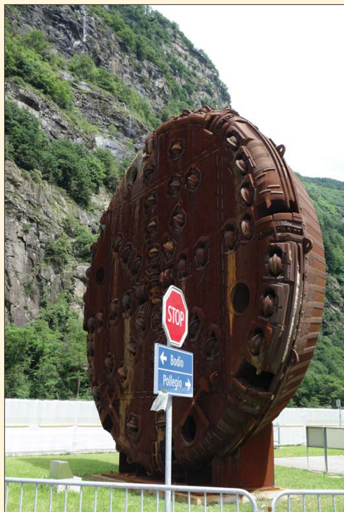
Obr. 1 Hlava TBM jako pomník Fig. 1 TBM cutterhead as a monument
