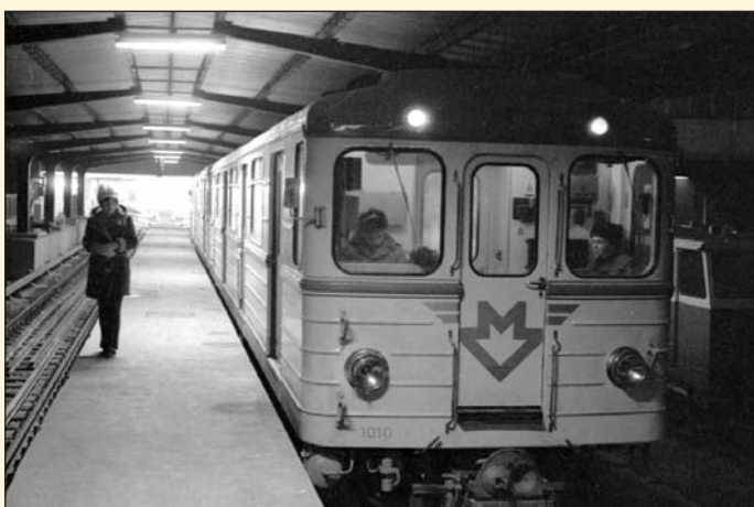
Obr. 1 Zkušební souprava 1010+1020 u služebního nástupiště u obrátových kolejí stanice Kačerov v lednu 1974 z depa k tomuto nástupišti tehdy ještě vlaky nemohly jet vlastní silou, ale přepravoval je sem lokotraktor
