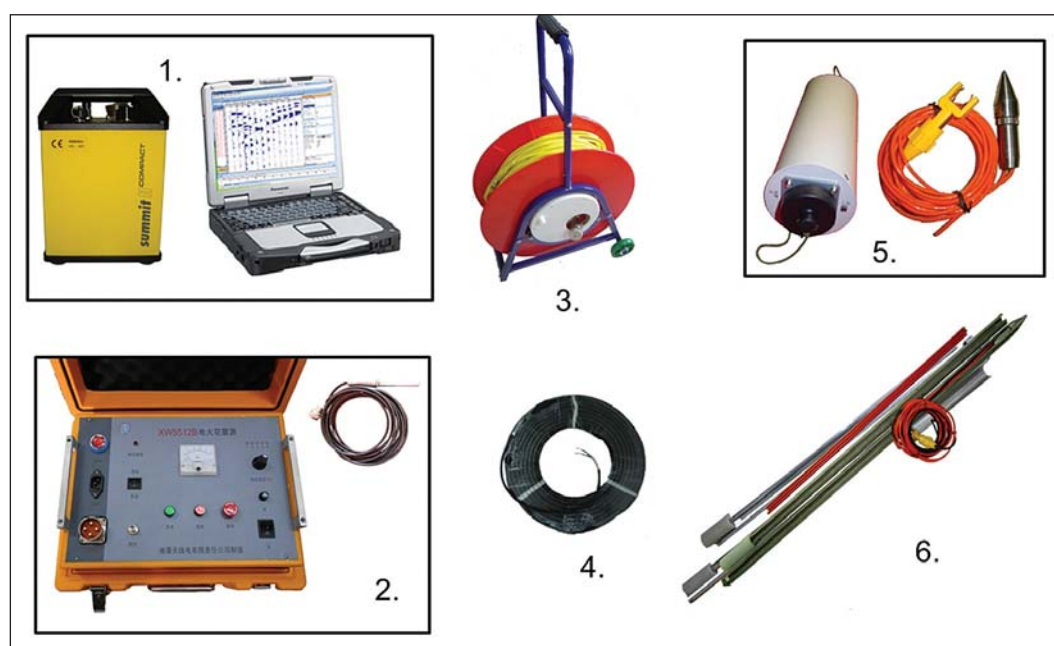
Obr. 6 Systém TST – používané přístroje: 1 – seismograf + laptop; 2 – roznětnice; 3 – datový kabel; 4 – spouštěcí kabel; 5, 6 – geofony, oddělovač signálů Fig. 6 TST system – equipment used: 1 – seismograph + laptop; 2 – sparker; 3 – data cable; 4 – trigger cable; 5, 6 – geophones, signal separator
