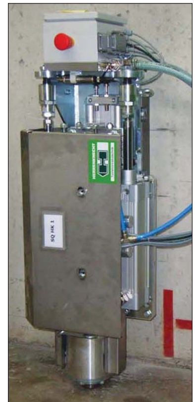
Obr. 8 Nárazové kladivo systému ISIS [3] Fig. 8 Impact hammer of ISIS system [3]
