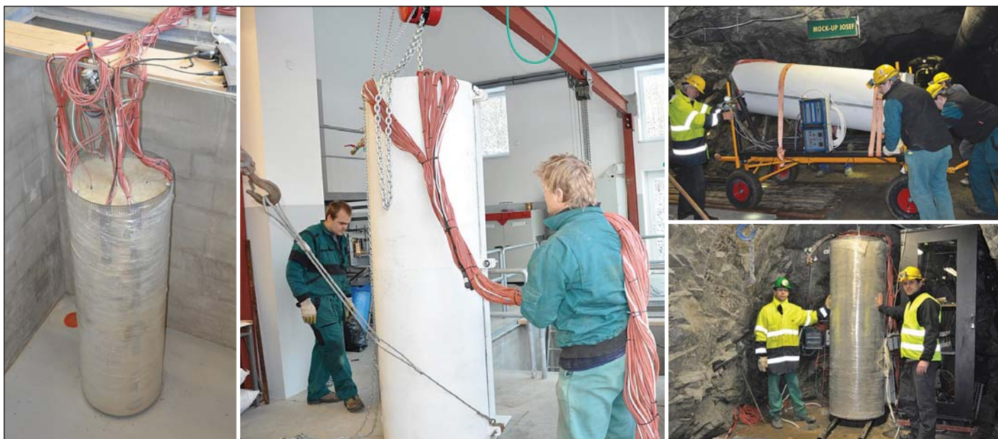
Obr. 5 Vlevo vystavený model v experimentálním silu před montáží převozního ocelového obalu, uprostřed model umístěný v převozním obalu, vpravo nahoře je obrázek z manipulace s modelem na transportním vozíku v místě realizace projektu a vpravo dole obrázek umístěného modelu nad úložnou studnou před spuštěním Fig. 5 Model constructed in the experimental silo before the installation of the steel transport shell on the left side; model placed into the transport shell is next to it; Right top – picture from the model handling on the transport trolley in the location of the project realisation; right bottom – a picture of the model above the well before lowering
