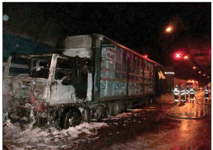
Obr. 2 Nákladní vozidlo s přívěsem těsně po likvidaci požáru Fig. 2 Truck with trailer just after suppression of the fire
