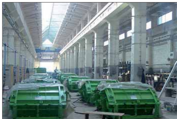
Obr. 10 Výroba segmentů ostění v Senci Fig. 10 Segment production in Senc
