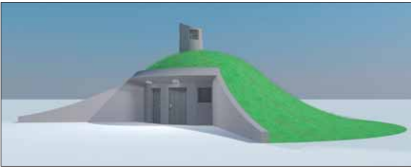
Obr. 4 Technologický domček pri únikovej šachte Fig. 4 Service house on the escape shaft
