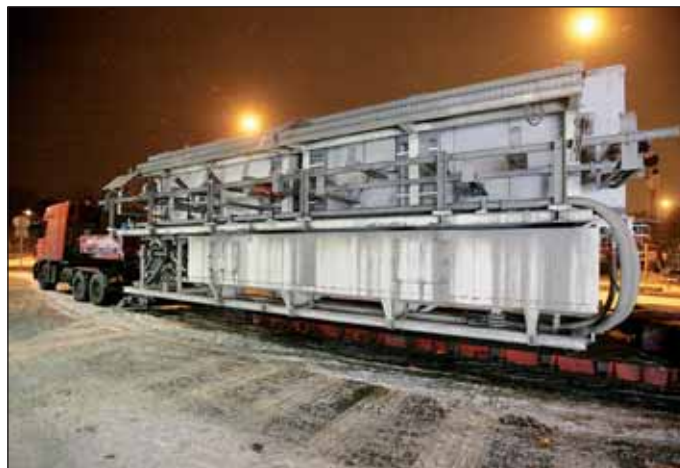
Obr. 2 Odvoz částí závěsu štítu EPB ze stavby (foto: Husák)
