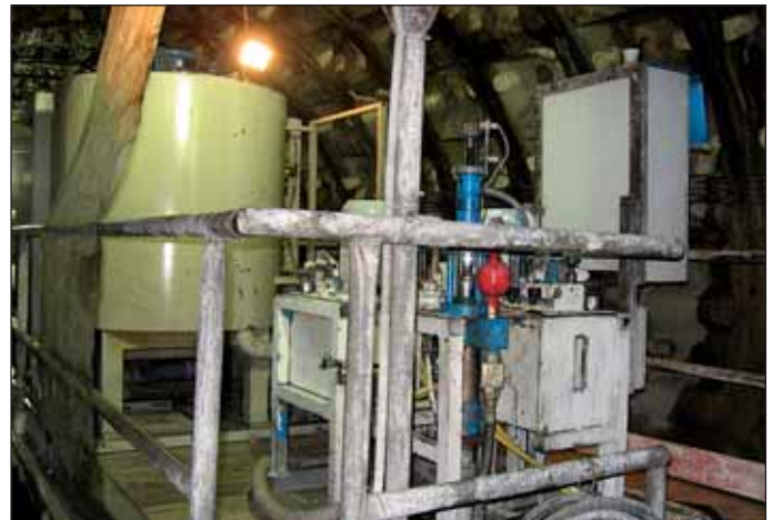
Obr. 8 Príprava zmesi pre chemickú injektáž Fig. 8 GROUTMASTER Mixer
