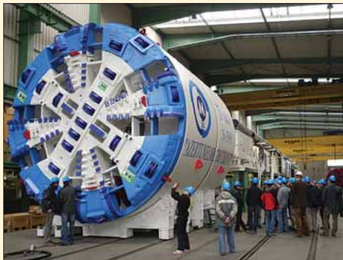
Obr. 3 TBM \phi 6 m připravený pro Baku (Ázerbajdžán) Fig. 3 TBM \phi 6.0m prepared for Baku (Russia)
