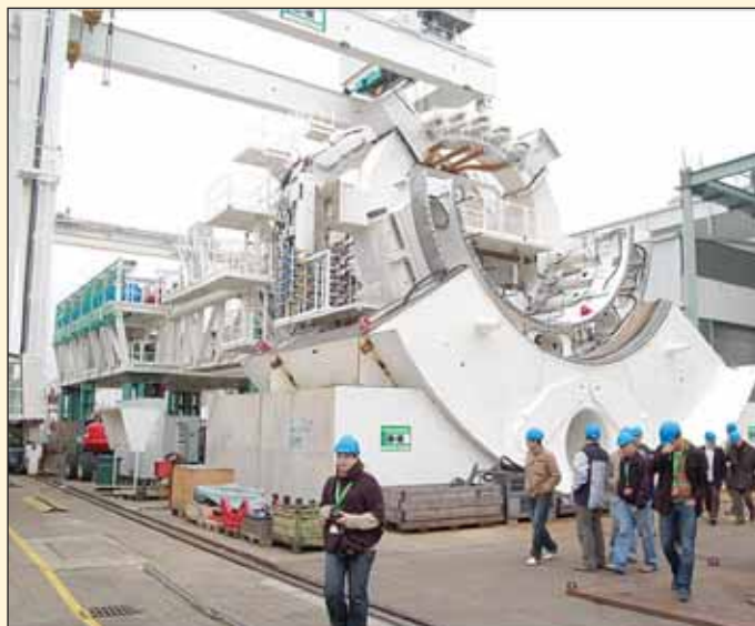
Obr. 5 Montáž největšího TBM \phi 15,55 m pro Itálii Fig. 5 Assembly of the largest, 15.55m diameter TBM manufactured for Italy
