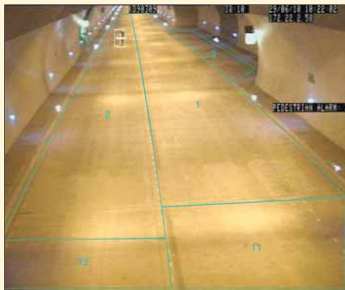
Obr. 1 Náhled jedné z kamer s virtuálními smyčkami a detekovaným incidentem (chodec)
