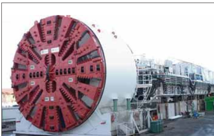
Obr. 1 Současná podoba technologie EPBS (archiv Metrostav a. s.) Fig. 1 Current EPB technology (Metrostav a. s. archives)
