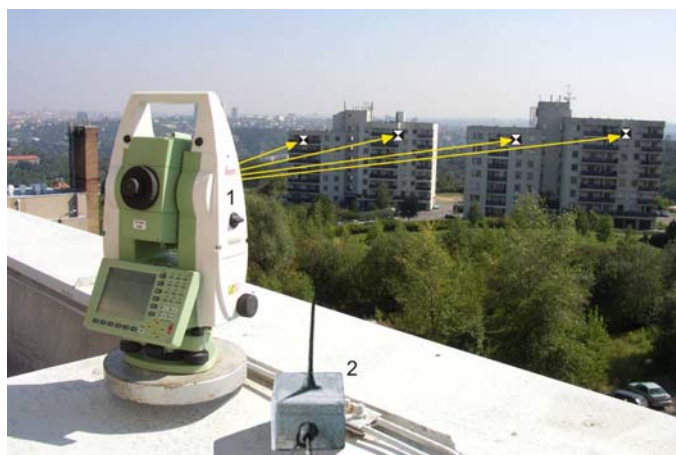
Obr. č. 2.4. Měření absolutních posuvů měřických bodů umístěných na objektech nadzemní zástavby optickými stanicemi
