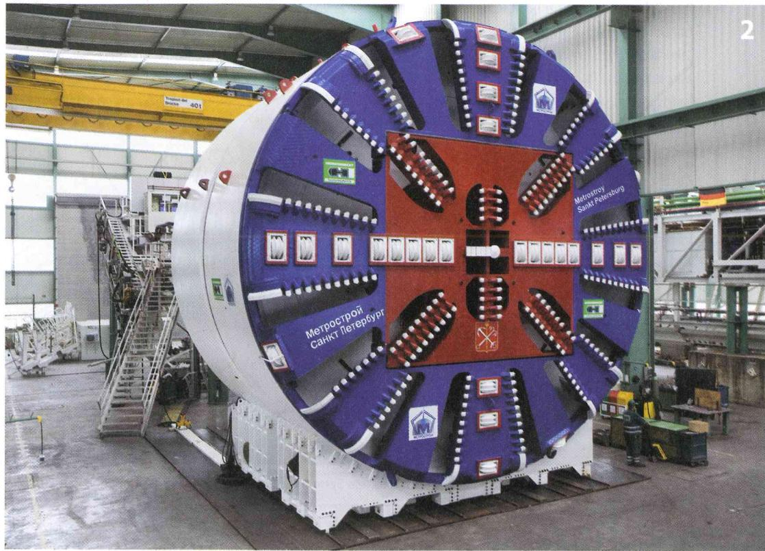
Der EPB-Schild S-441 (10,69 m Durchmesser) für den Schrägschachtvortrieb in St. Petersburg
