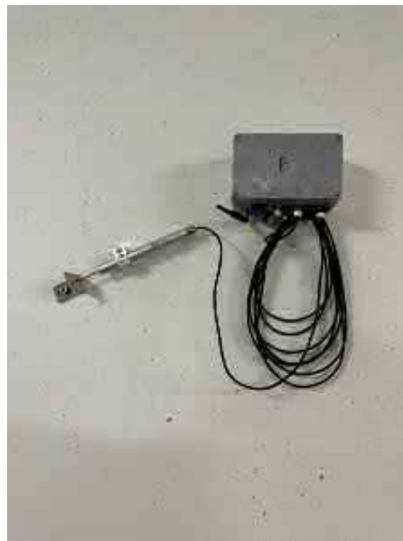
ASD deformetr na trhlině
