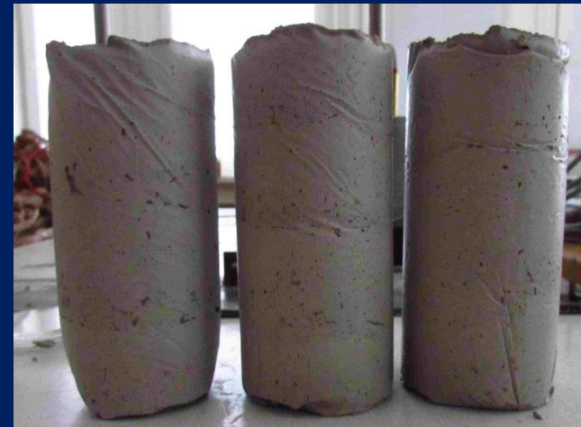
měřící vzorek : válec o průměru 60 mm a výšce 130 mm
