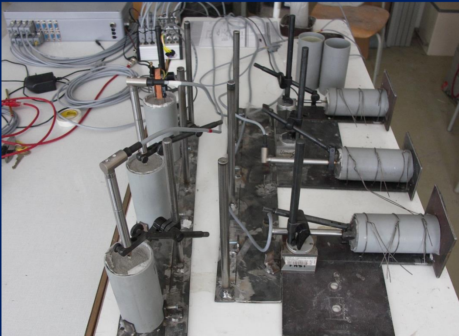
měřící vzorek : válec o průměru 60 mm a výšce 130 mm
